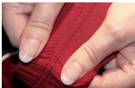
ПРОВЕРКА ШВА: БЛАГОДАРИ ЛЁГКИМ ТЯНУЩИМ ДВИЖЕНИЯМ МОЖНО УВИДЕТЬ ПОВРЕЖДЕНИЕ МАТЕРИАЛА. (РИС. 2)
