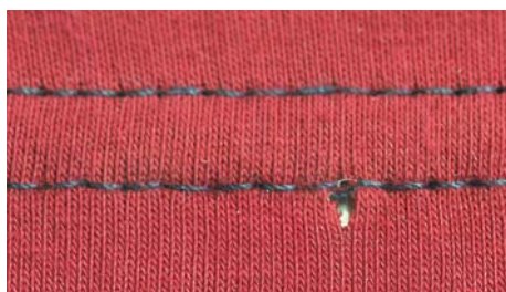
РИС 2. ПОВРЕЖДЕННЫ ПЕТЛИ - ТЕСТ ПРОДОЛЖАЕТСЯ С МЕНЬШИМ НОМЕРОМ ИГЛОЙ.
