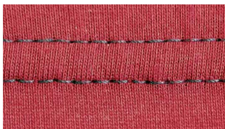
РИС 3. БОЛЬШЕ НИКАКИЕ ПОВРЕЖДЕНИЯ МАТЕРИАЛА НЕ ВИДНЫ - ПРАВИЛЬНАЯ ТОЛЩИНА ИГЛЫ НАЙДЕНА.
